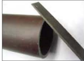
写真2 カエリ除去作業
