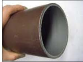
写真3 カエリ除去後の状態
