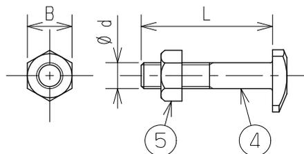
SUS製T字ボルト・ナット寸法表 単位：mm
