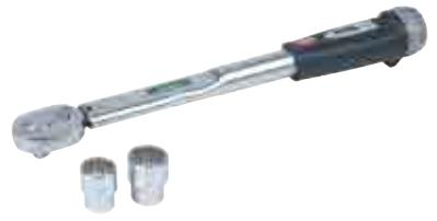
プリセット形トルクレンチ(ダイレクトセット・ホールドタイプ)ですので各サイズのボルトナット締付時に下記のトルク値に手動にて設定の上、片締めにならないよう注意して締付けて下さい。(設定トルク値に達するとトルクレンチのヘッド部からカチッと音がします。)
