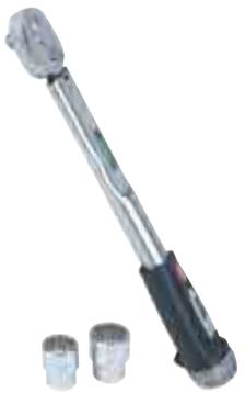
プリセット形トルクレンチ(ダイレクトセット・ホールドタイプ)ですので各サイズのボルトナット締め時に下記のトルク値に手動にて設定の上、片締めにならないよう注意して締め付けて下さい。(設定トルク値に達するとトルクレンチのヘッド部からカチッと音がします。)
