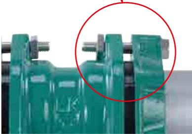
●六角ボルトⒶを締め付けることにより、止水パッキンⓑが圧縮され、ロックエース継手本体Ⓒ側に圧縮固定されます。
